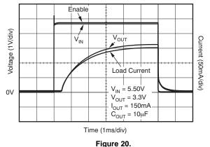
**ENABLE PIN vs OUTPUT VOLTAGE DELAY**
